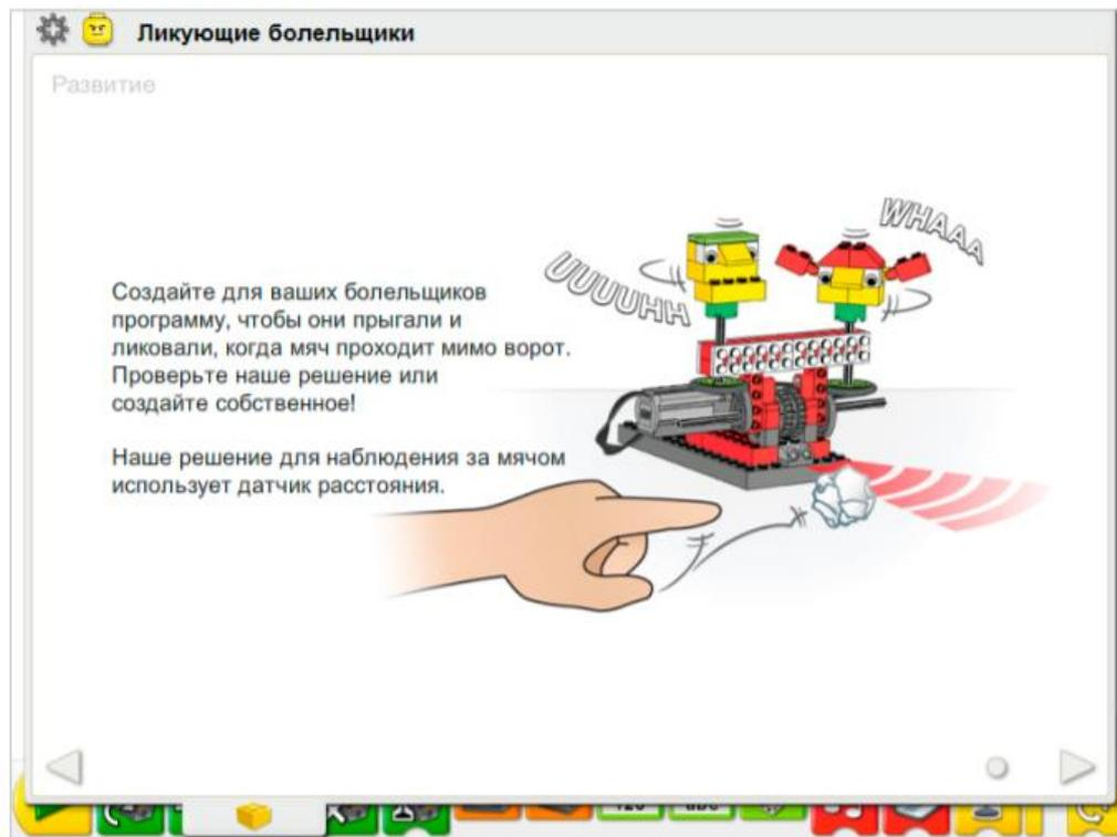
Необходимо установить на модель датчик расстояния в соответствии с пошаговой инструкцией. Датчик расстояния, как и мотор, подключается к любому порту ЛЕГОкоммулятора.
